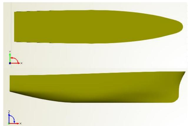
Figura 3. Modelo paramétrico do casco
