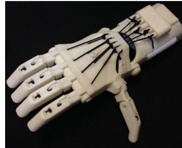
Figura 1. Prótese manufaturada através de FDM.
