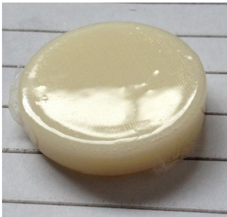
Figura 3. Corpo de prova após o ataque de acetona.
