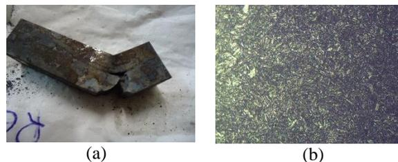
A figura 6 mostra a microestrutura da amostra sem nenhum tratamento térmico. A microestrutura é grosseira mais heterogênea. Todos os aços tratados partiram dessa microestrutura.
