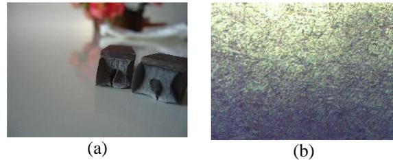
A Figura 5 mostra o material revenido a 600°C, após o ensaio Charpy, 58,5 J. É absorvido elevado valor de energia. Não houve a fratura completa do CP. A amostra para micrografia foi extraída do lado direito da amostra.
