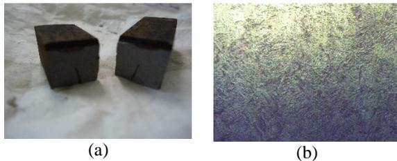
Na figura 3 é possível perceber que o corpo de prova apresentou maior área cisalhada o que dificultou a fratura aumentando os valores de energia absorvida. A microestrutura não é tão refinada e há uma maior decomposição dos carbetos formando uma estrutura de ferrita fina acircular.
