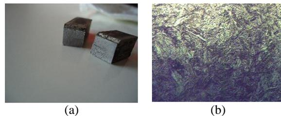
Na figura 1a mostra uma fratura frágil, típica da microestrutura tensionada formada na têmpera e mostrada em 1b.
