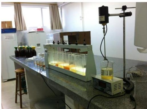
**Figura 1 – Jar-test utilizado no experimento**
