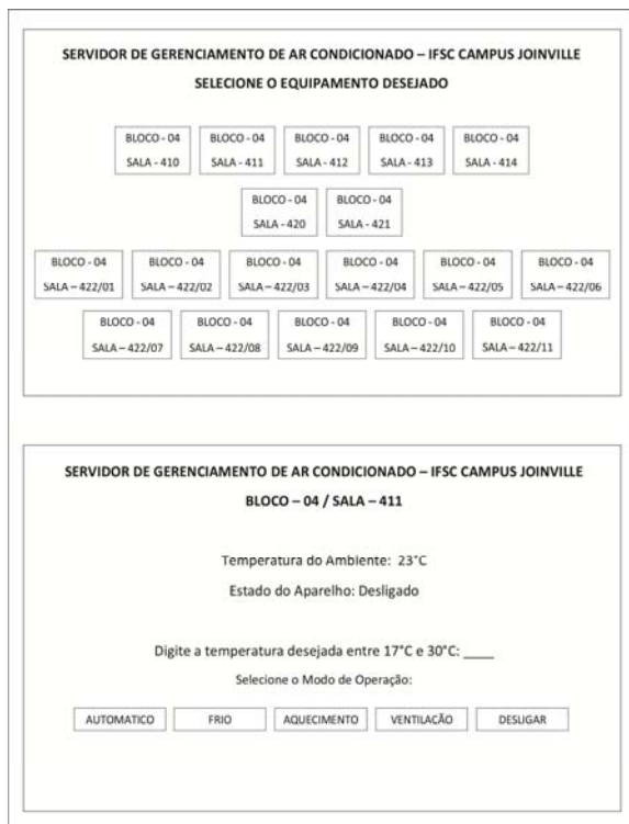
Figura 4 - Exemplo das páginas de internet utilizadas para controlar os equipamentos de ar condicionado.
