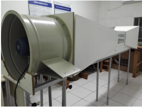
Figura 1 – Túnel de vento construído no CEM.
