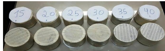
Figura 02: Aspecto Corpos-de-Prova após ensaio com parafina
